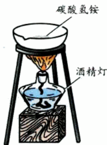
图 1-7 加热碳酸氢铵固体
