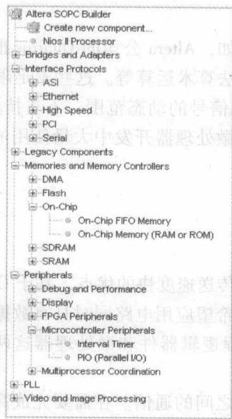
图 1.2 Nios II 软核处理器外围模块的配置窗口
