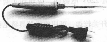
图 1.2.1 内热式电烙铁
