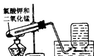
\*6. 指出实验室用氯酸钾制取氧气装置图（如右图）的四处错误，并改正：
