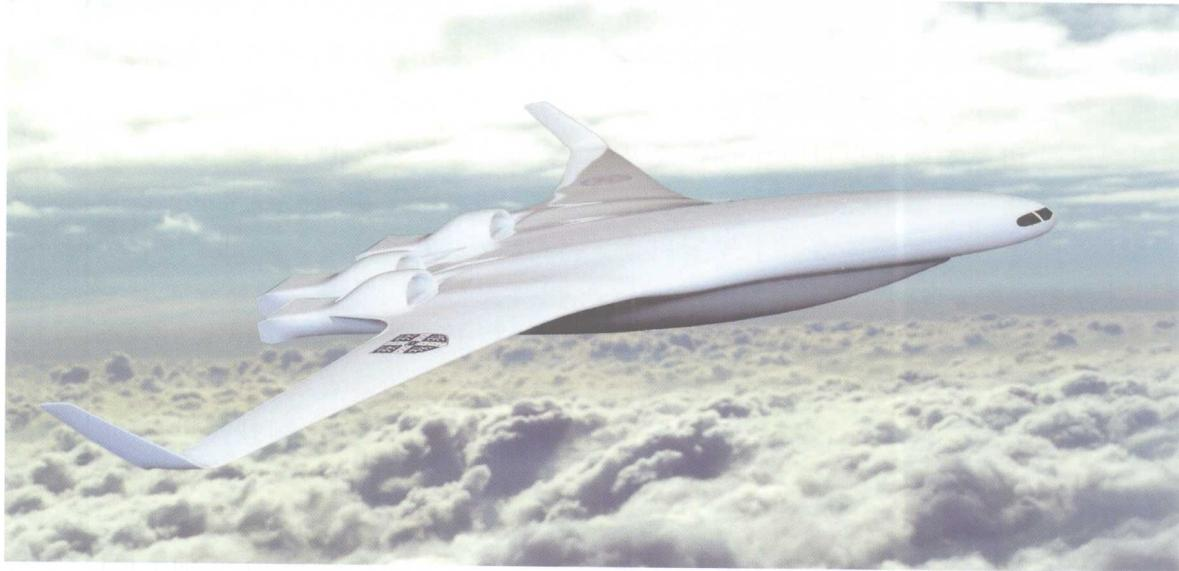
近年来，美国NASA和波音公司都开展了深入的飞翼飞行器研究。NASA早在2005年就在全尺寸风洞中试验了飞翼5%缩比模型的自由飞特性，内容包括在低速飞行包线边缘（无发动机条件）的稳定性和操纵性能评估。现在，NASA正在针对未来空中运输设想方案中各种布局的优点，在持续不断的系统研究基础上，考虑飞翼的改进，诸如引入混合层流控制和埋入式发动机等先进技术，以进一步发挥飞翼设计的最大潜力。波音公司则在2006年5月4日正式公开了两架翼展为6.4m的X-48B原型机缩比模型分别用于风洞试验和飞行试验的信息。2007年7月20日，X-48B技术验证机在加利福尼亚州爱德华空军基地首飞。随后，研究人员将把X-48B关注的重点转向低噪声特性。
