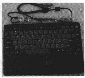
图 1-4 计算机键盘数据线只有 7 根
