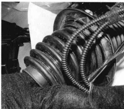
图 4-10 光缆摩擦部位会造成光损失
