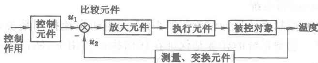
图 1-5 炉温自动控制系统的功能方块图
