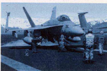
和维护性好、生存能力强、大迎角飞行性能好、武器投射精度高。据介绍，该机的机体是按 6 000 飞行小时的使用寿命设计的，机载电子设备的平均故障间隔长，故障率低，电子设备和消耗器材中 98% 有自检能力。
