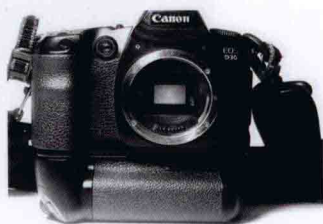
佳能公司自主生产的第一部数码单反相机EOS D30，图片所示的是相机加上电池盒的样子
