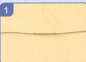
将两条金属丝头尾相接拧成一条长金属丝。
