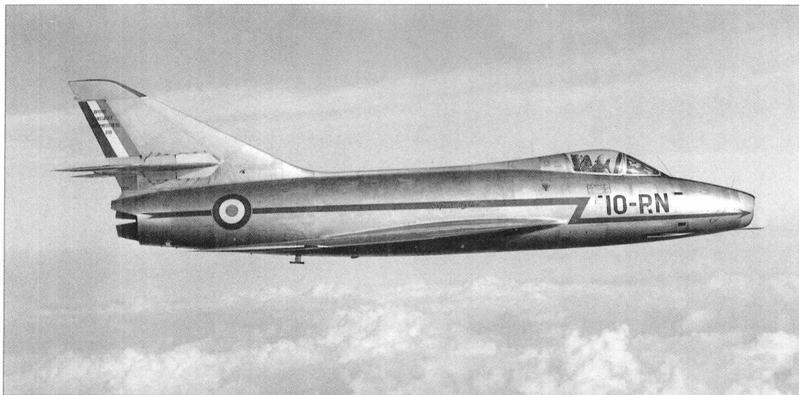
↑虽然在许多重要的外形特点上与F-100“超级佩刀”式战斗机相类似(45度后掠机翼、动力控制厚片水平尾翼以及平圆形的进气口),但是“超神秘”却是在F-100和米格-19之后欧洲第一种真正意义上的超音速战斗机。图中这架飞机涂有代码和红色闪电标志(图中为黑色)。请注意这架飞机尾部的加力燃烧室喷口带有粗糙的半圆形调节片。
