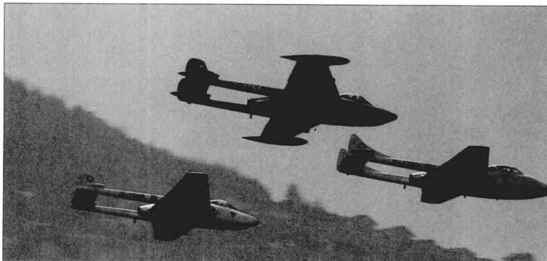
← 两架瑞士空军“吸血鬼”式飞机（一架T.Mk55型和一架装有侦察用机头舱的FB.Mk6型）正在与一架“恶毒”式飞机（近景）编队飞行。最初一些瑞士官员曾认为豪客公司的“海恶妇”式飞机比“吸血鬼”更适合于装备瑞士空军。
