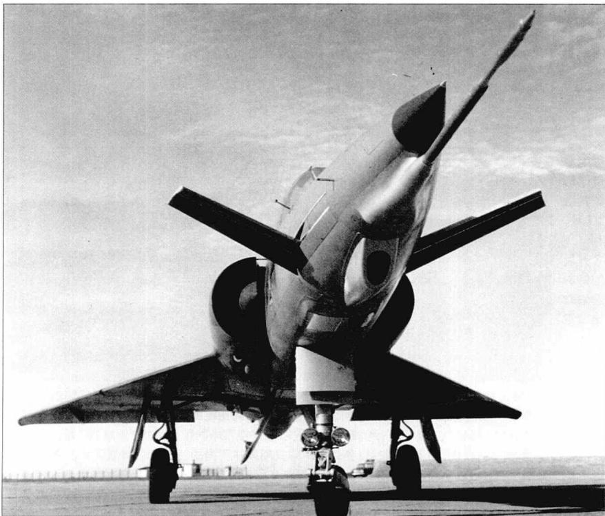
←以色列曾计划通过“米兰”计划与瑞士合作改善“幻影”5的低速操纵性和在野战机场的短距起降性能。虽然最终并没有根据这个计划制造出生产型飞机，但是实验过程中飞行性能的成功提升使得以色列决定在其研制的“幼狮”飞机上安装鸭式前翼。
