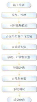
图 1-17 空调工程安装流程图
