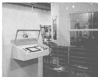
工业中心为 HAESL 设计制造的自动回转式无损检验系统
