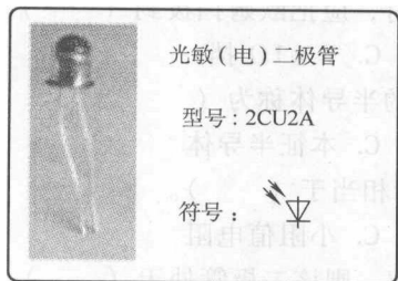
图 1-8 光敏二极管的符号和实物图
