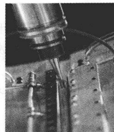
图 0-2 针销搅拌产热、塑化材料实现焊接(摩擦搅拌焊接中,轴肩放置在金属的表面,经由摩擦产生热)
