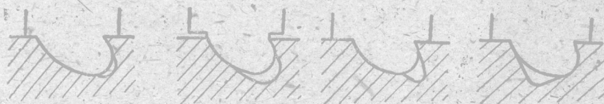
图 5 拉刀齿槽齿的最后制成
