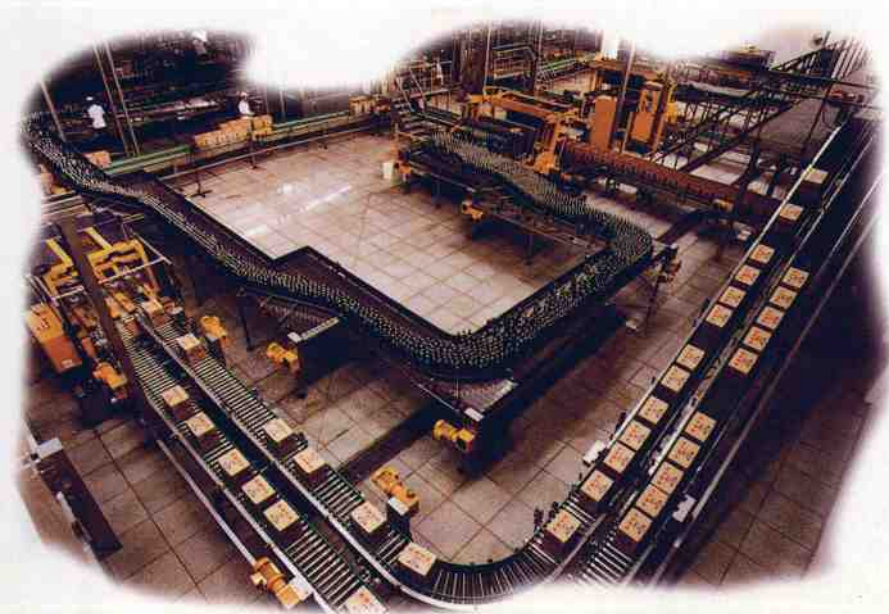
中外合资万泰啤酒有限公司是中国西南最大的啤酒生产企业。上图为该公司具有 90 年代先进水平的生产线外景，下图为从德国进口的 3.6 万瓶 / 小时啤酒灌装生产线
