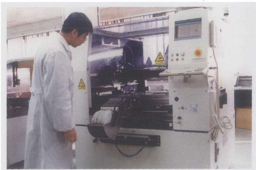
公司板极产品的生产采用了先进的表面贴装生产工艺
