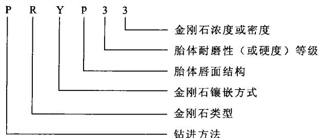
如 PRYp33 表示人造金刚石孕镶普通双管平底形钻头，金刚石浓度为 75%，属于中等耐磨性胎体（相当 HRC35~40 热压胎体）。但在下述品种中第五、第六位数字一般不标出，由用户根据岩层性质和钻进条件，向制造厂提出。
