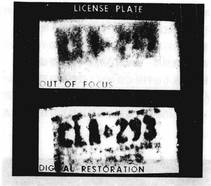
圖 1 - 4 影像處理法可以使模糊不清的車牌照照片變得清楚。
