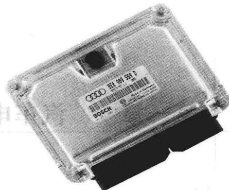
图 1—2 奥迪汽车 ECU 外观图
