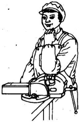
图 1-2 台虎钳的合理高度
