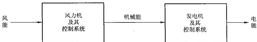
图 1-1 风力发电的能量转换过程
