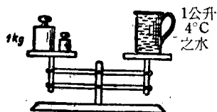
第10圖 1 公升 4^\circ\text{C} 之水重 1 公斤。左邊之小砝碼係作平衡右邊容器皮重之用。
