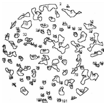
图 1.5 基于 CT 扫描的沥青混合料试件
