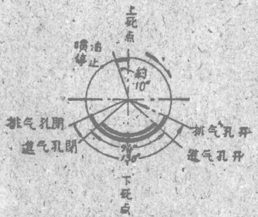
图2 热球式发动机定时图
