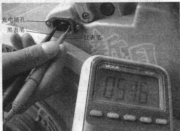
图 1-2 蓄电池组充电插孔电压的测量
