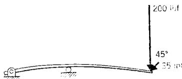
2-21 求下圖作用於太空旋轉車 (skycycle) 之合力。
