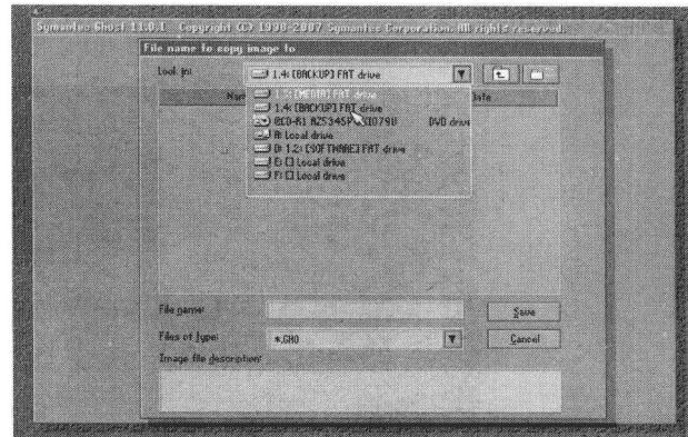
6. 点击“Save”后显示如下界面，进行压缩方式的选择。此处有三种压缩方式，应根据自己的情况进行选择。“No”:不压缩，占用磁盘空间最大，所需时间最短；“Fast”:快速压缩，占用磁盘空间居中，所需时间居中；“High”:高压缩比，占用磁盘空间最少，所需时间最长。
