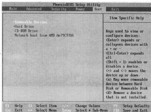
3. 根据屏幕右方提示进行选项设置。利用向下箭头“↓”选中“CD-ROM Drive”，按键盘上的“+”号，将“CD-ROM Drive”置于其他启动项的上方，完成计算机从光驱启动的设置。
