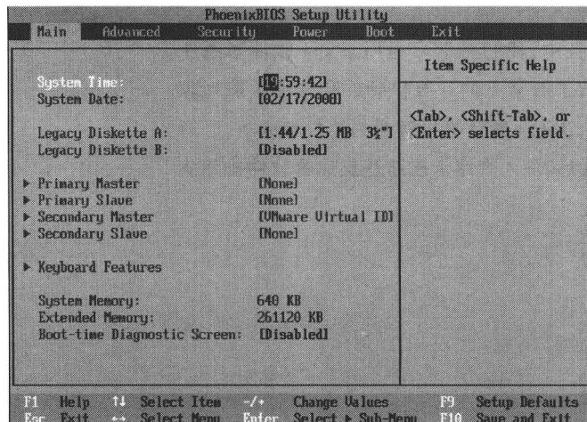
2. 参照屏幕下方提示说明进行操作。左右方向箭头用来选择顶部蓝色背景菜单，上下方向箭头用来选择屏幕中央各个设置项。利用向右箭头“→”将光标定位到 Boot 选项。
