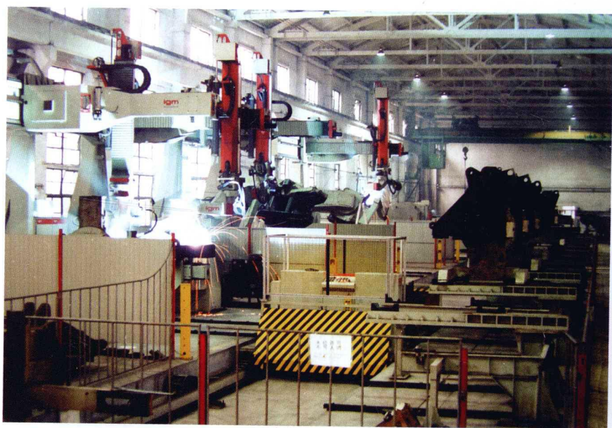
柳州工程机械厂全自动机器人焊接生产线。
