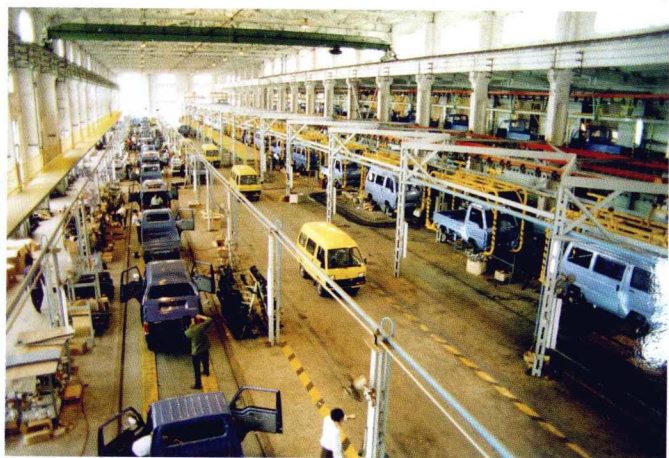
柳州微型汽车厂“五菱”牌微型汽车总装生产线。
