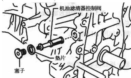
图 1-17 拆卸控制阀滤清器
