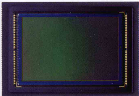
▲ 约2110万有效像素的全画幅CMOS图像感应器
