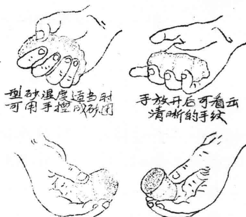
图1~3 手捏法检验型砂
