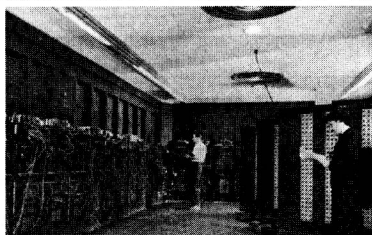
图1-8 电子管计算机 ENIAC
