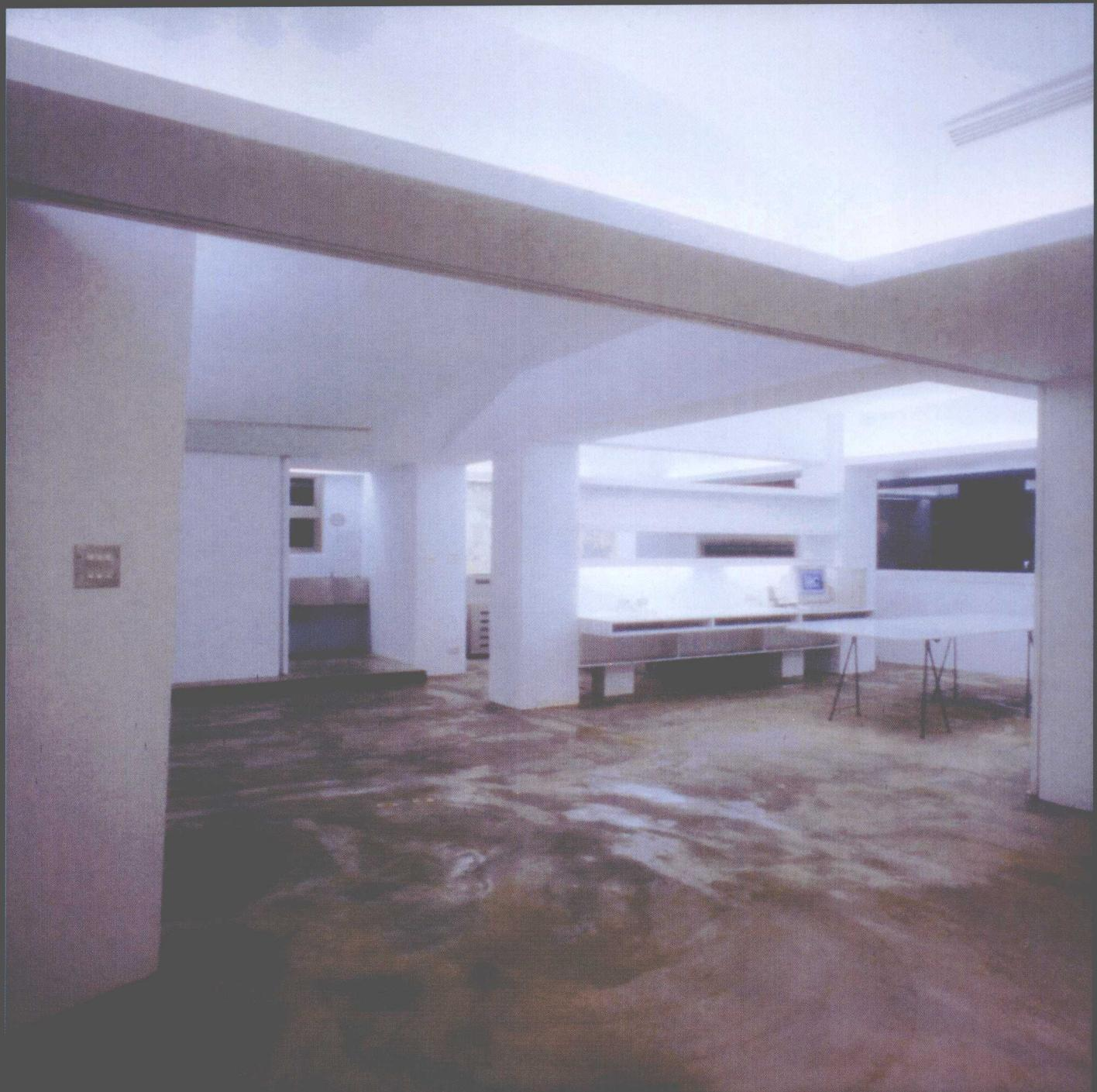
这里，陆希杰却做了‘一次施工’的实验。墙面赤裸裸地呈现了原有壁纸被撕下后的粗糙质感；地面也仅涂上水泥后再敷上透明漆。顶棚则是利用原来的顶棚与梁柱改成局部顶棚，处理成一种类似顶楼的感觉。一次施工、不但节省工时，也让空间的传达更为直接也更有特色。陆希杰说，不装涂的斑驳墙面，不但是对空间的诚实；墙面的粗糙质感，也是一种自然、不
