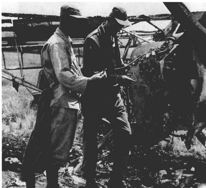
空袭腾冲的美军战机，亦有发生故障坠落的情况。图为一架坠毁的L-5飞机，此机乘员两人，负责空地作战联络。照片拍摄时间为9月4日。
