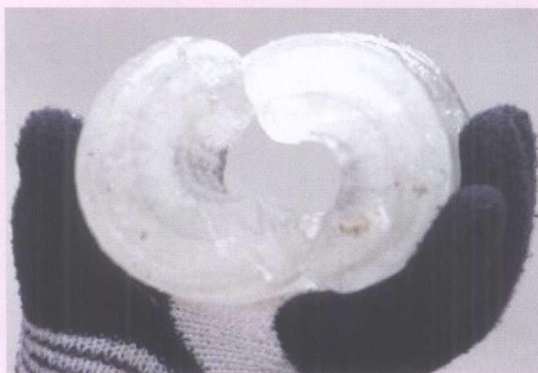
电线覆冰厚度达到电线直径的两倍
