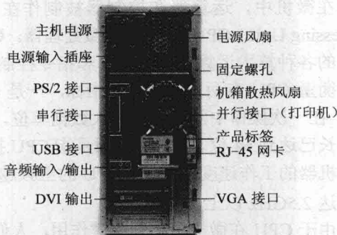
图 1-3 计算机主机箱背板外观
