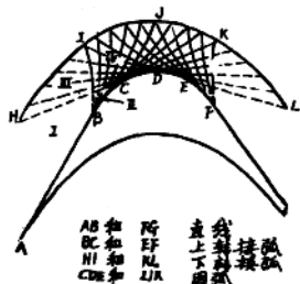
图 6 超音速有旋流动的冲击式槽道设计
