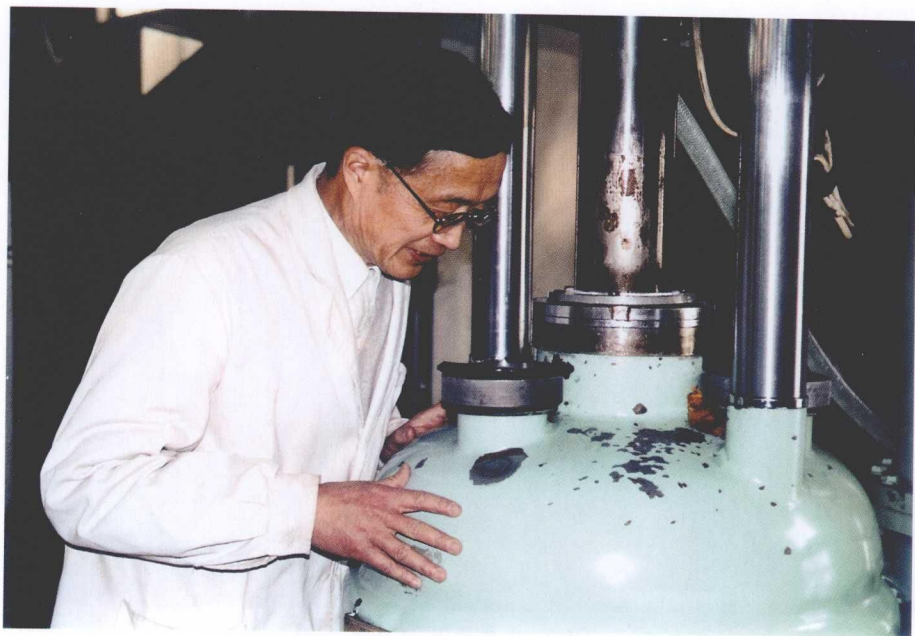
曹春晓正通过观察窗监视钛合金在真空自耗电弧炉内的熔炼过程
