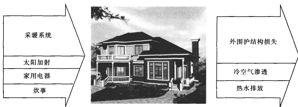
图 1-4 建筑得热和失热因素示意图
