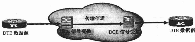
图 1.3 数据通信系统的构成
