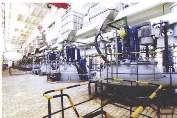
亚星化学公司引进德国生产技术和设备建成的氯化聚乙烯 ( CPE ) 生产装置氯化岗位一角
