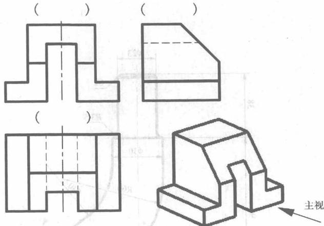
2.3 看懂立体图，将图中的长度、宽度、高度等尺寸数字填在横线上。
