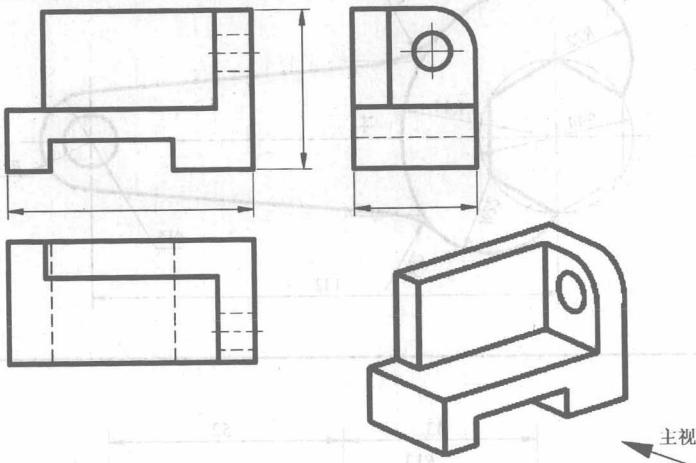
2.4 参照立体图，在三视图中填写物体上、下、左、右、前、后的方位。
