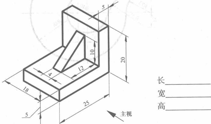
2.2 参照立体图，在三视图尺寸线中填写“长、宽、高”。
