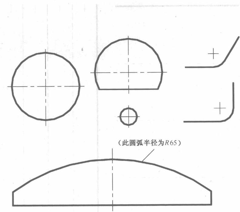
1.6 找出上图中尺寸注法的错误，并在下图中正确地标注。
