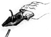
(1)用钢丝钳剪断金属线
