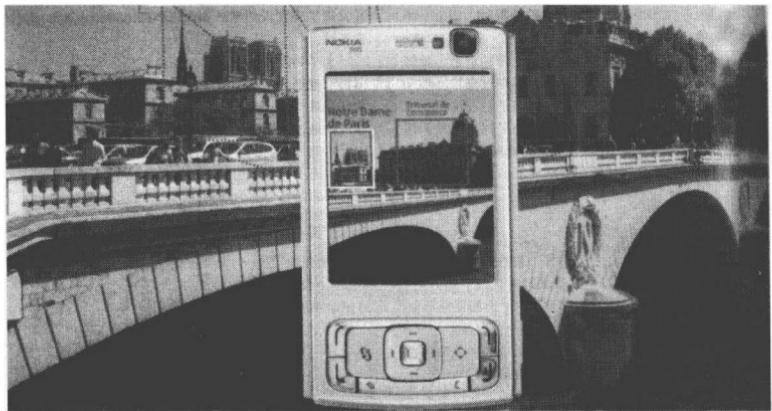
这是配有增强现实系统的诺基亚手机原型。它配备了摄像头、全球定位系统和指南针，可以迅速显示用户眼前的景点名称和简单的介绍
