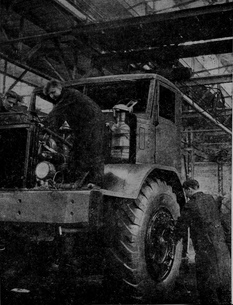
明斯克汽車工廠出產了巨大的二十五噸的自動卸貨卡車，供給偉大的共產主義建設工地使用。圖為工人們正在裝配自動卸貨卡車的情形。
