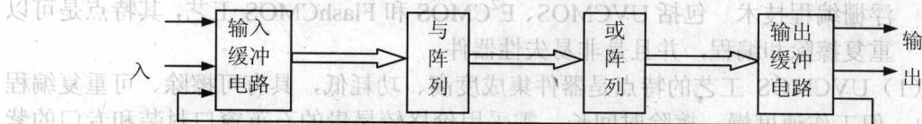
图 1-3 PLD 基本组成原理结构图
