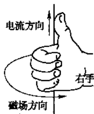
图 1—4 载流直导线周围产生的磁场
