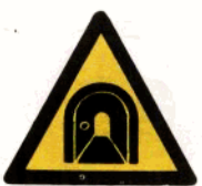
图 26 隧道 设在隧道较长、视 线不良、照明不好 的隧道口。
