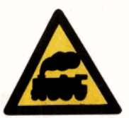
图 30 铁路道口 设在铁路道口以 前。
