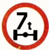
图 62 限制轴重 设在需要限制轴重的 桥梁两端。
